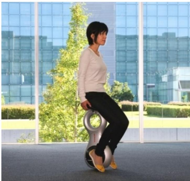
در کنار سیستم کنترل تعادل اختصاصی هندای که از تحقیقات دینامیک گام برداشتن رباط شبه انسان ASIMO توسعه یافته است، برای حرکت کردن نرم در تمامی جهات، این وسیله به اولین چرخ تمام جهته دنیا مجهز شده است. همانند Segway، سرعت این وسیله با متمایل کردن وزن بدن تنظیم می شود. این وسیله نه تنها جلو و عقب می رود، بلکه به لطف چرخ تمام جهته ابتکاری هندای که به چپ و راست نیز حرکت می کند.
