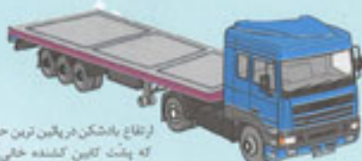
ارتفاع بالاترین نقطه بادشکن با ارتفاع بار حمل شده یکسان است.
