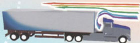
عدم وجود بادشکن باعث آشفتگی جریان هوا در پشت کابین راننده شده است.
