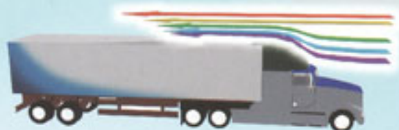
بادشکن از پخش هوا پشت کابین راننده جلوگیری نموده و مقاومت هوا را کاهش می دهد.
