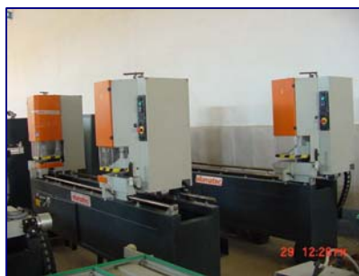
شکل ۱- تصویری دستگاه برش دوسر پروفیل پی وی سی
