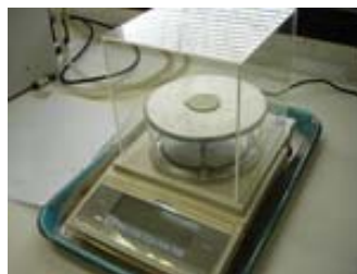
شکل ۵: ترازوی آزمایشگاهی برای اندازه گیری وزن نمونه و ظرف آن در آزمایش خواص انتقال بخار آب ساخت کارخانه سارنورپوس کشور سوئیس
