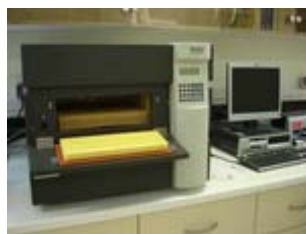
شکل ۶: دستگاه تعیین ضریب هدایت حرارتی عایق های حرارتی با روش جریان حرارت سنج ساخت کارخانه نچ آلمان
